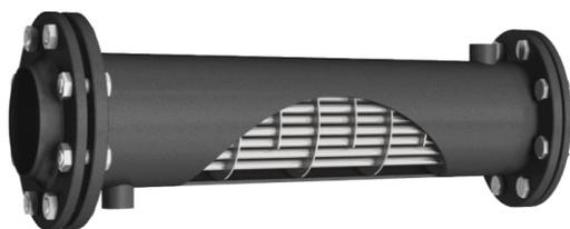
ACW - доохладители с водяным охлаждением разработаны для снижения температуры сжатого воздуха и регулировки точки росы газа под давлением в системе сжатого воздуха. Горячий сжатый воздух/газ проходит через трубы. Охлаждающая вода постоянно проходит вокруг труб противоположным потоком. АСА доохладители обеспечивают максимальную производительность и защиту всего оборудования, например холодоосушителей,
