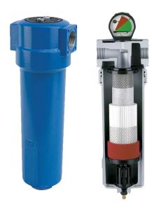
АF фильтры разработаны для высокоэффективного удаления твердых частиц, воды, масла, углеводородов, запахов и паров из систем сжатого воздуха\*. Для достижения требуемого качества сжатого воздуха необходима установка соответствующего фильтроэлемента (B, P, R, M, S, A, A2, H2, MS2). \*
